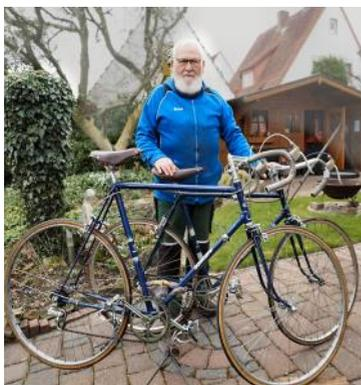
Das Bild zeigt zunächst die Bahnsportmaschine mit 3-Gang-Original-Schaltung und 28-Zoll-Bereifung ohne Schläuche aus dem Jahre 1948, genannt „Das Blaue Wunder“. Der einzige Unterschied zur Ursprungsversion ist, dass sie nicht mehr die Holzbereifung trägt, mit der sie anfangs ausgeliefert wurde.
